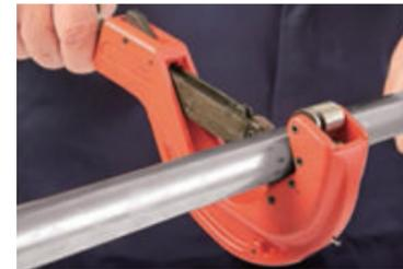
请使用适当的管材切割工具，推荐使用班尼戈定制的专用配套工具，注意垂直切割管材端，确保管材端口圆形并无损伤，请参考班尼戈推荐的定制工具清单（割管刀）。
